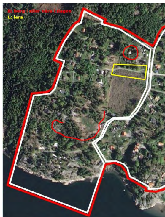
Figur 3: Översiktlig jordartskartering från platsbesök år 2014 i delområde 1 för dåvarande detaljplanegräns. Bilden är hämtad från tidigare utredning [2] . Röd markering (bortsett från avgränsning) är berg i eller nära i dagen. Gul markering är lera.
