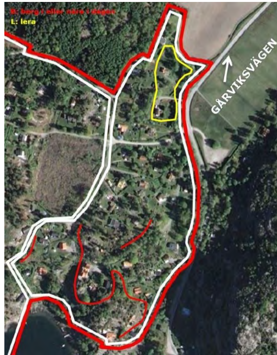
Figur 5: Översiktlig jordartskartering från platsbesök år 2014 i delområde 2 för dåvarande detaljplanegräns. Bilden är hämtad från tidigare utredning [2] . Röd markering (bortsett från avgränsning) är berg i eller nära i dagen. Gul markering är lera.
