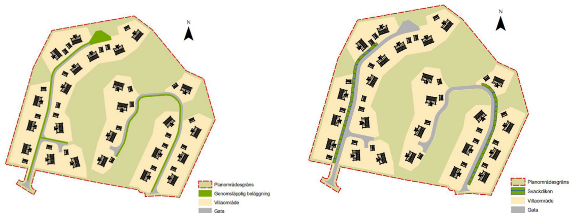
Alt 1. Ytbehov för föreslagen permeabel beläggning
