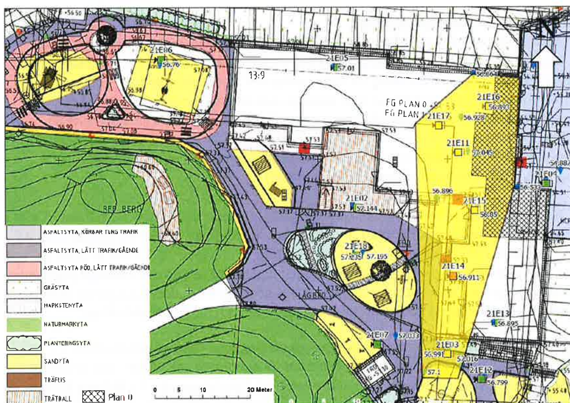
Figur 6. Gult fält symboliserar ungefärligt område där förorening överskridande KM har påträffats. Den största delen av området utanför huskroppen avses täckas med asfalt eller marksten. En mindre del av området planeras dock utgöras sand- eller planteringsytor.
