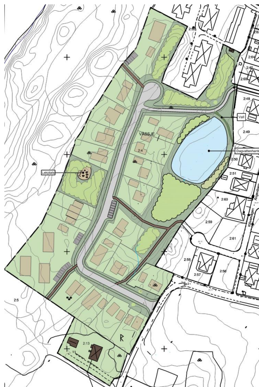
Figur 1: Urklipp ur illustrationsritning där planerad dagvattendamms placering i plan framgår.
